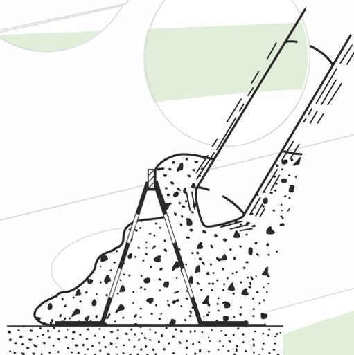
При обработке глубинным вибратором полость внутри рельс заполняется бетоном
