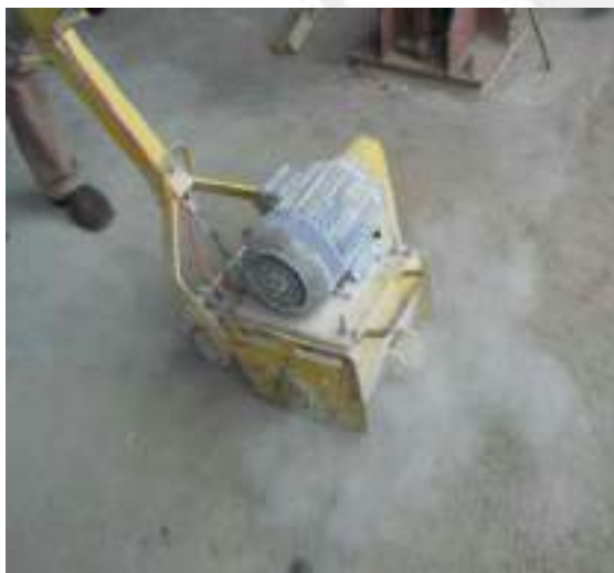
Рисунок 20 - Роторно-фрезеровальная машина с карбидно- вольфрамовыми фрезами типа Airtex ES-200EL
