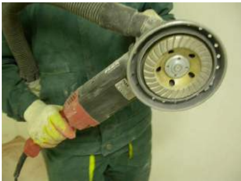
Рисунок 24 - Ручной бетоношлифовальщик с алмазной фрезой
