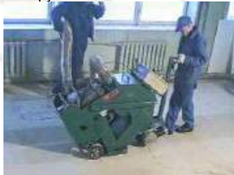
Рисунок 16 - Обработка поверхности дробеструйной машиной типа Blastrak
