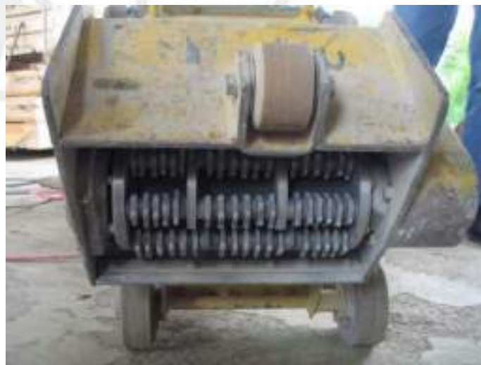
Рисунок 20 - Роторно-фрезеровальная машина с карбидно- вольфрамовыми фрезами типа Airtex ES-200EL
